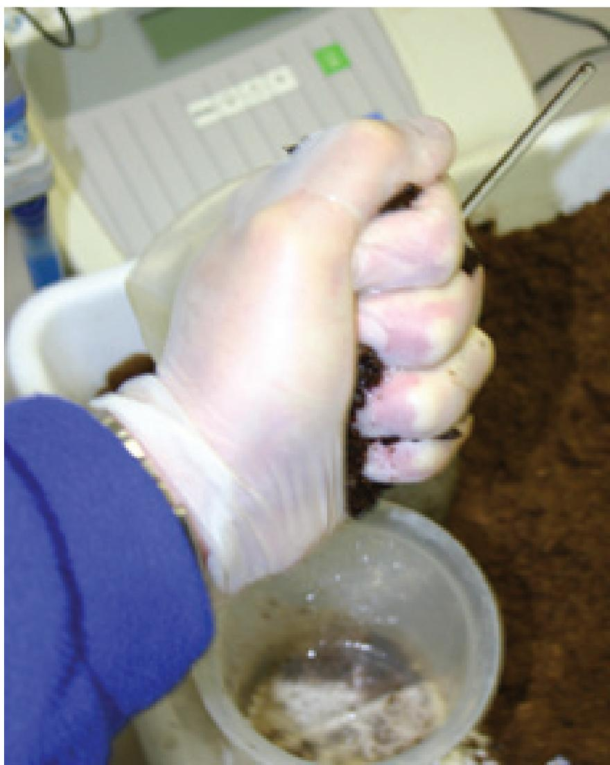
Test per la misura del grado di decomposizione secondo il criterio Von Post
