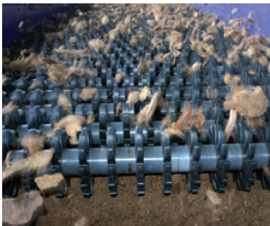
**In alto:** Frazioni granulometriche di torba di sfagno ottenute per selezione meccanica con vagli stellari; **sotto:** dettaglio di un vaglio stellare in funzione.
