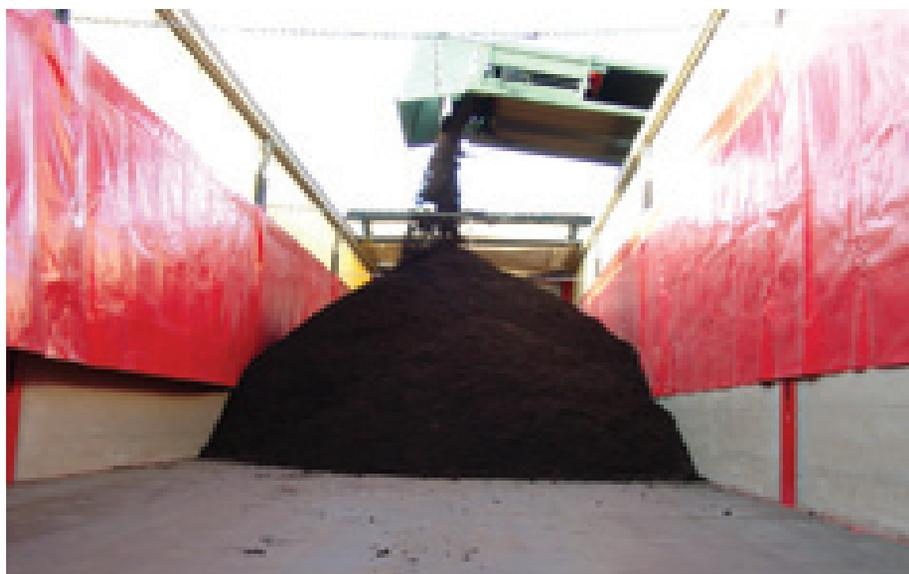
*Operazioni di carico di veicolo adibito al trasporto di substrato sfuso*
